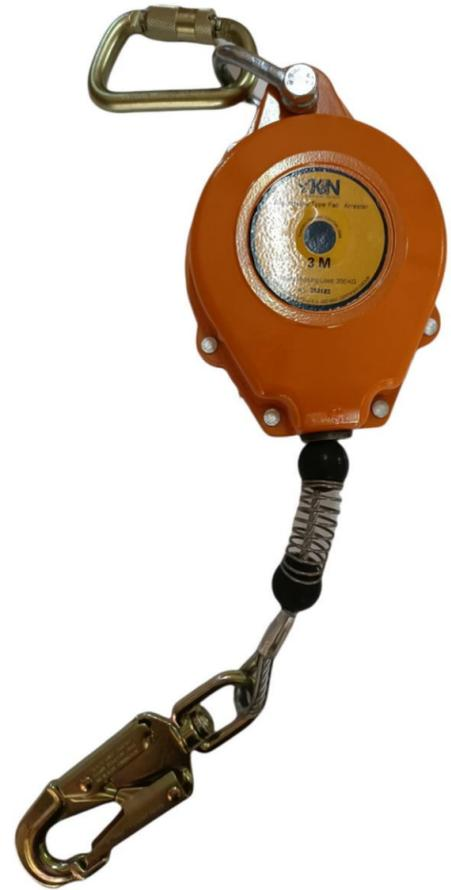
El Bloque Retráctil Fijo anti-caídas está diseñado para usarse como dispositivo de protección contra caídas para una sola persona. Cuentan con un punto de anclaje fijo, una carcasa de alta resistencia de polímero, un sistema de frenado único que facilita los golpes en caso de una caída, cable de acero galvanizado, con indicador de impacto o caídas “Jebe con resortes” el cual tiene que permanecer sin ninguna deformación para su apto funcionamiento y un gancho de seguridad giratorio de acero.
